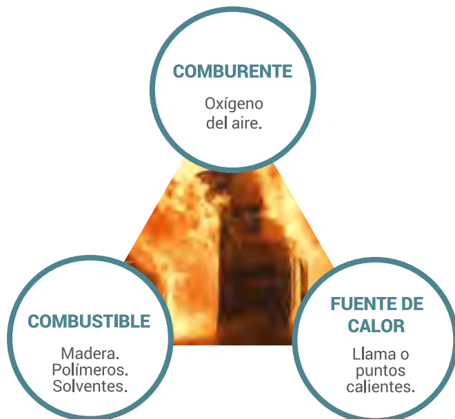
FIGURA 23.- El triángulo del fuego.
