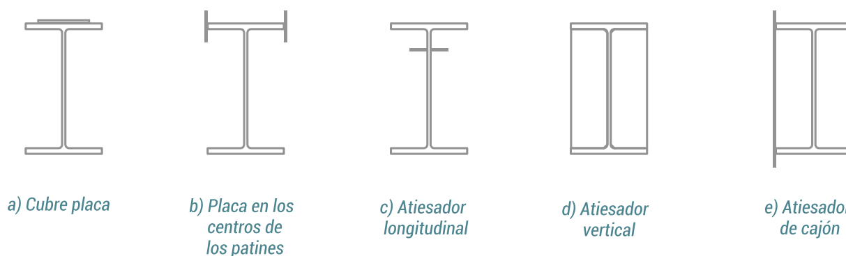
Figura 10. Formas de rigidizar perfiles tipo IR para evitar inestabilidad local.
